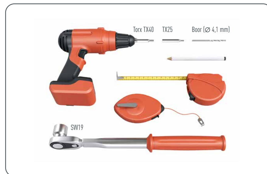
Afbeelding 90 · Sneeuwvanger voor berggebieden – benodigd gereedschap
